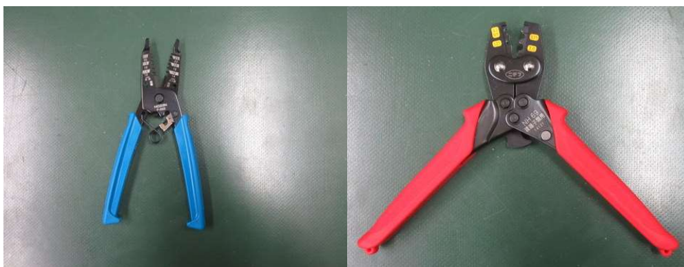
ワイヤーストリッパー（電線をむく道具）圧着工具（電線に圧着端子を付ける工具）
